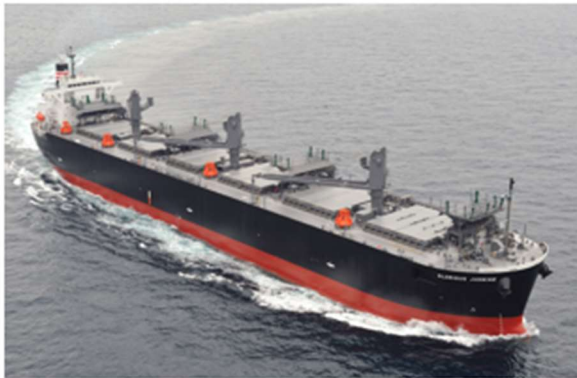
船名： MV GLORIOUS JASMINE 船種： チップ船（385万cft型） 全長： 210m 全幅： 32.26m
