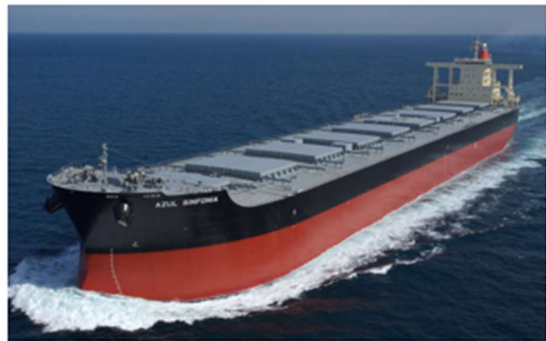
船名： MV AZUL SINFONIA 船種： ばら積船（18万t型） 全長： 292m 全幅： 45.0m
