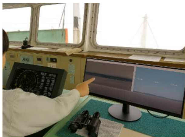
写真2：船橋に設置したAIカメラモニター
